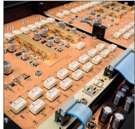
Relais sorgen in der Bivium für die Pegelinstellung und die Eingangswahl
